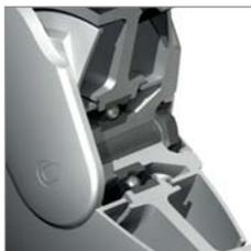
Структура, разработанная для защиты подшипника колеса.
